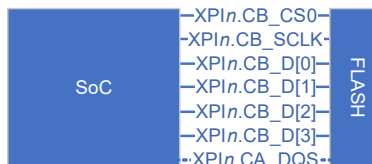
图 14: XPI QSPI NOR FLASH CB 端口连接
