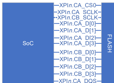
图 15: XPI Octal NOR FLASH 连接
